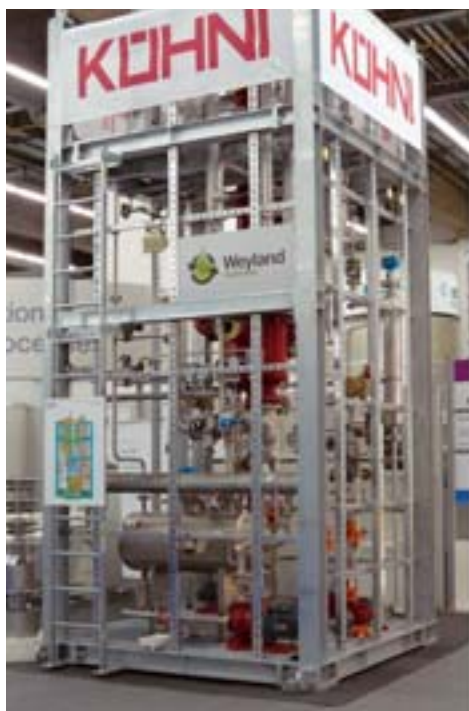
Auf der Achema 2009 präsentierte Kühni die für Weyland A/S geplante und als Skid zusammengefügte Anlage zur Säure-Rückgewinnung (links). So sah die mit Tricad MS geplante Anlage im CAD-Modell aus (rechts).
