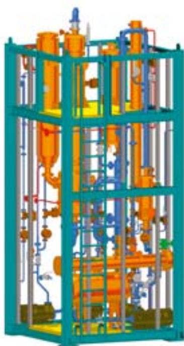
Auf der Achema 2009 präsentierte Kühni die für Weyland A/S geplante und als Skid zusammengefügte Anlage zur Säure-Rückgewinnung (links). So sah die mit Tricad MS geplante Anlage im CAD-Modell aus (rechts).
